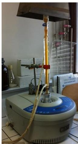
*Figure 2.5 : Photo du montage à reflux utilisant un four à micro-ondes pour l'oxydation des DWNTs par la Méthode 4.*
