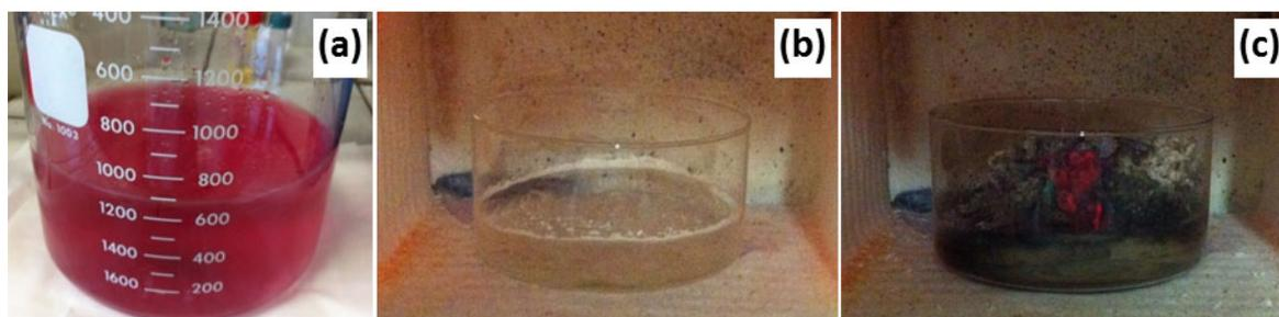
Figure 2.1 : Photos de la solution préparée à partir de l’acide citrique et de sels métalliques à (a)  $t = 0$ , (b)  $t = 2$  min et (c) à  $t = 10$  min de combustion dans un four à moufle à  $550^{\circ}\text{C}$ .
