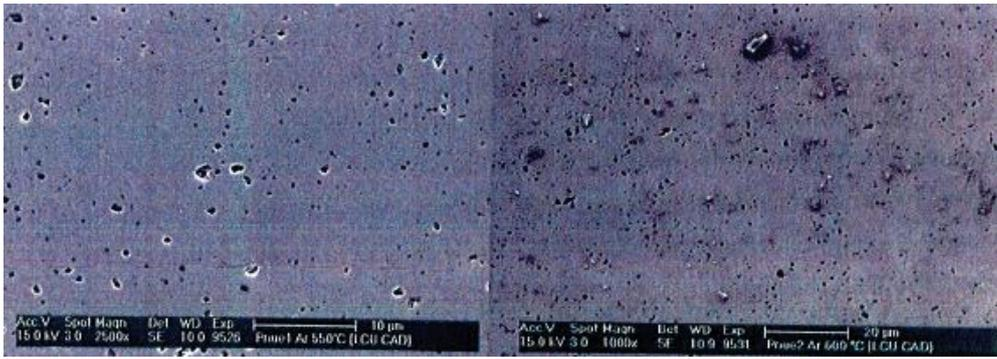
Figure I.23. Observation au MEB des pastilles  $\text{UO}_2$  après cycle de pyrolyse sous Ar-N55 à 550 °C (gauche) et 600 °C (droite) [HANUS 2007]
