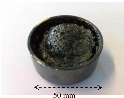
Figure IV.5. Exemple d'un résidu de pyrolyse dans la petite nacelle après un traitement réalisé avec le four d'essai
