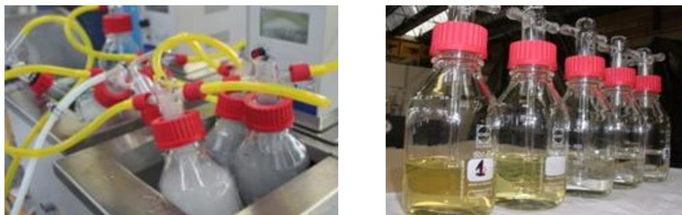
Figure A.16. Dégagement de la fumée issue du four au sein des barboteurs. b. Ensemble des flacons laveurs à la fin d'un essai.
