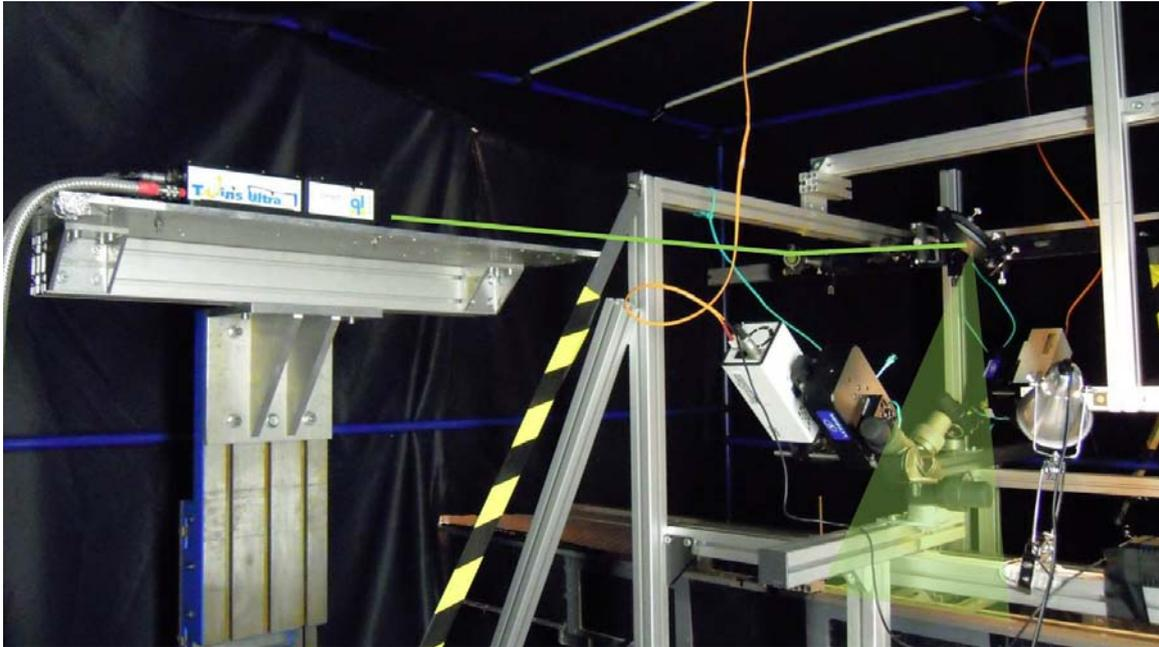
**FIGURE 2.7** – Photographie du dispositif de mesure stéréoscopique PIV installé sur le canal durant la réalisation des expériences.
