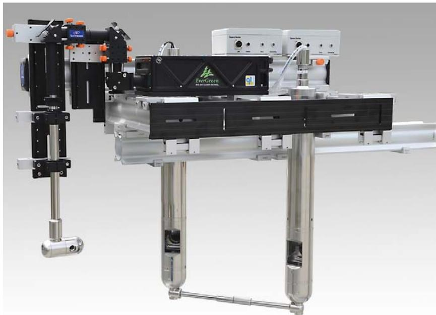
**FIGURE 2.4** – Système de mesure SPIV de type "boroscope" submersible intégré développé par la société LaVision.
