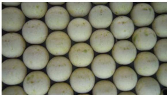
**FIGURE 2.6** – Photo des rugosités de fond - hémisphères de diamètre  $d = 4$  cm.
