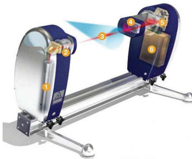
**FIGURE 2.12** – Schéma de principe du système de mesure Spraytec : (1) laser HeNe, (2) optiques, (3) Zone de mesure, (4) Lentille de Fourier, (5) Capteur, (6) Système d'acquisition des données (*source : Malvern*).
