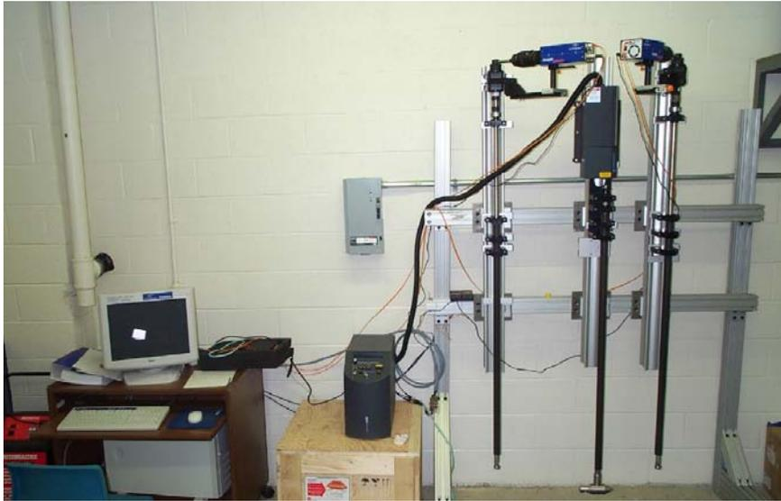
**FIGURE 2.3** – Système de mesure SPIV submersible de type "boroscope" utilisé dans les travaux expérimentaux de [Xu et al. \(2007\)](#).
