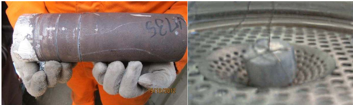
Figure 4-5 : Tronçon de tube de la ligne A3VM35 et échantillon hydrolysé.
