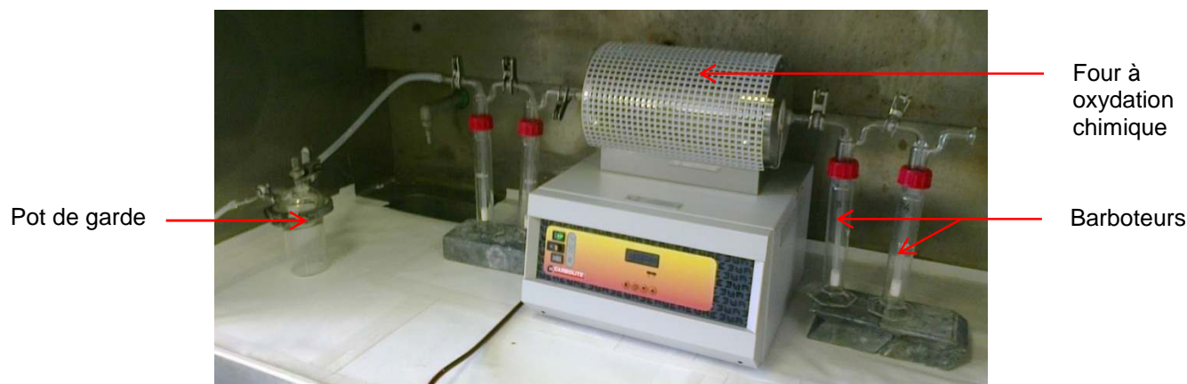
Figure 4-3 : Dispositif de piégeage du tritium.
