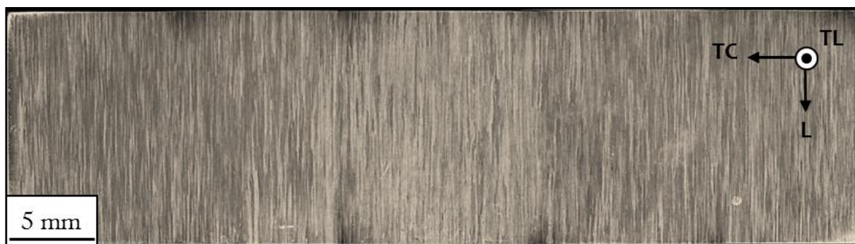
Figure III-7 : Micrographie optique du plan (L-TC) de la tôle étudiée de l'alliage AW2050 à l'état T34 (épaisseur de la tôle).
