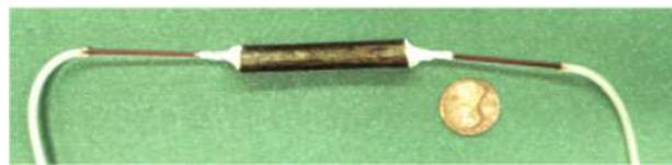
FIGURE 3.1 – Perfusion d'un unique vaisseau de xylème sur une section de branche dans le but de mesurer la conductance du xylème en fonction de la composition de la sève [Zwieniecki 2001b].
