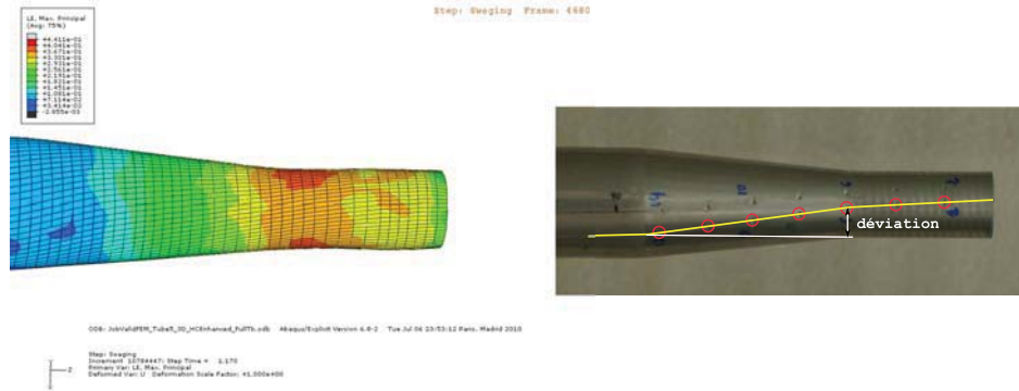
FIGURE 4.13 – Données géométriques pour la validation du modèle numérique
