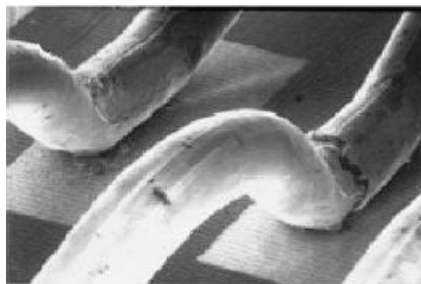
Figure 1-42 : Fissure au niveau d'un pied de fil de câblage [Ciappa 01].
