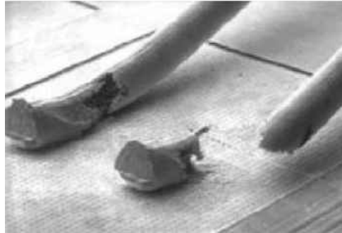
Figure 1-40 : corrosion d'un fil de connexion [Ciappa 01].
