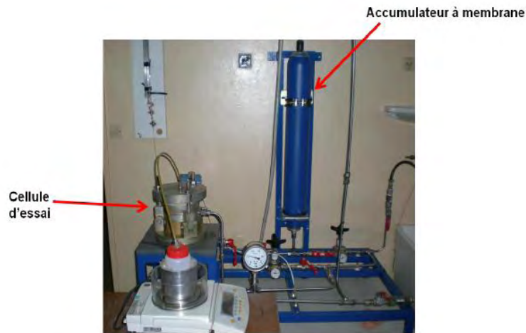
Figure V – 10 : Perméamètre au liquide développé au LMDC
