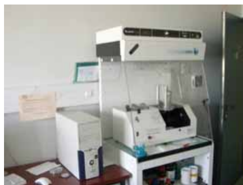
FIGURE 2.15 – Dispositif expérimental de caractérisation des angles de mouillage.
