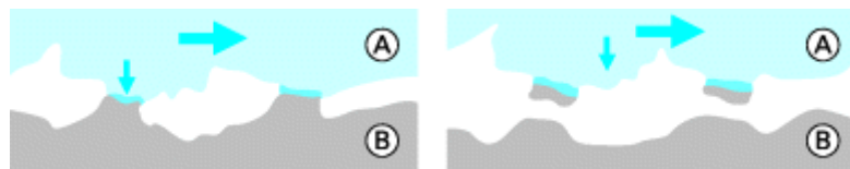
Figure 8 : Usure adhésive et formation de transfert [26]
