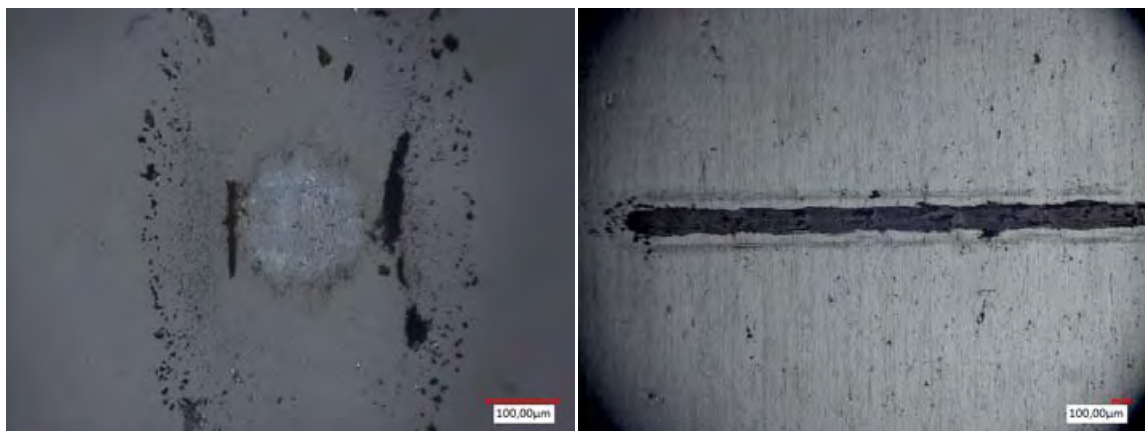
Figure 2 : Micrographies optiques des faciès d'usure de la bille en alumine et de l'acier inoxydable 15-5PH « laminé miroir » ( R_a = 0,03 \mu\text{m} ) après 1000 cycles de frottement
