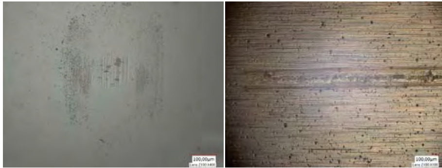
Figure 59 : Micrographies optiques des faciès d'usure de la bille et du revêtement chargé à 30 g/L et traité thermiquement à 300°C après 1000 cycles de tests tribologiques
