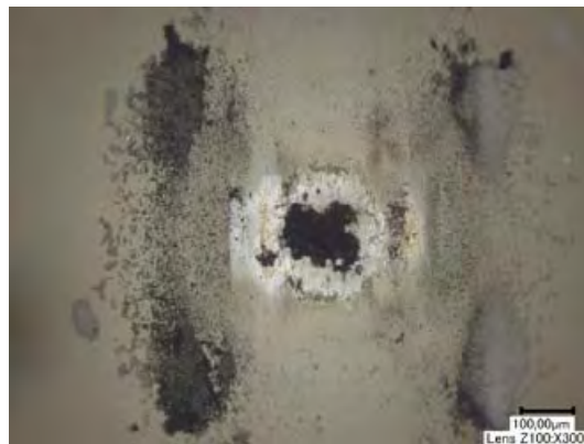
Figure 7 : Micrographie optique de la bille après 1000 cycles
