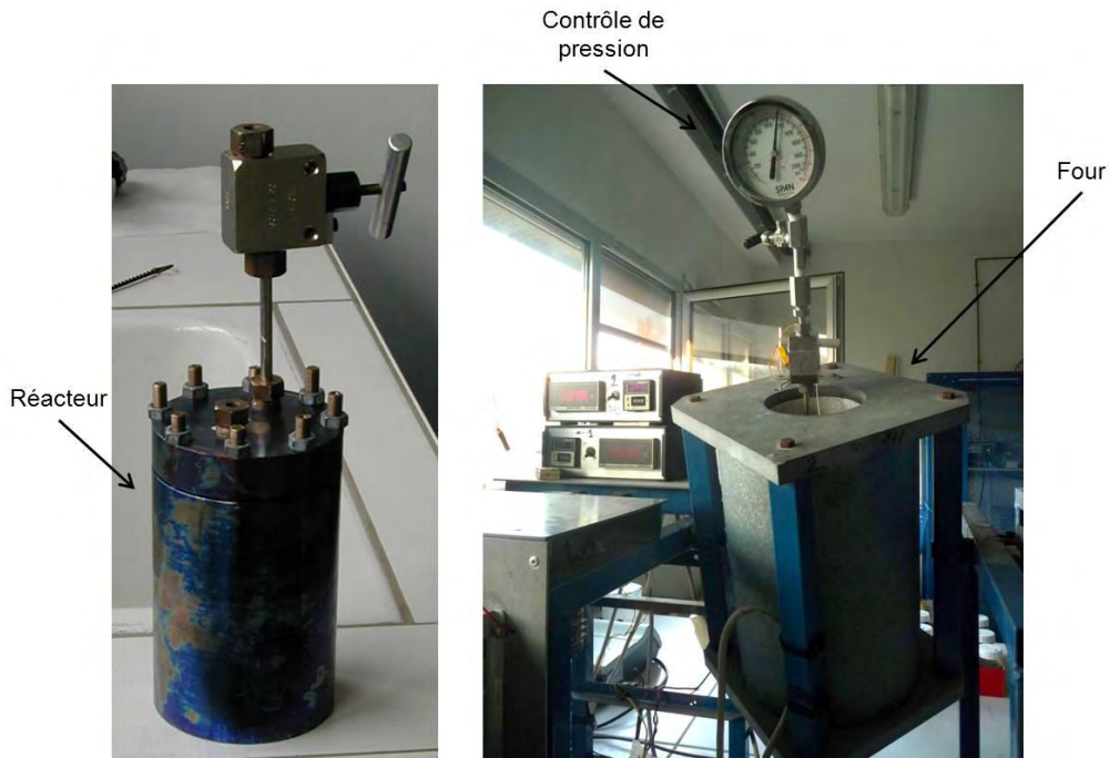
Figure II.1 : Réacteur de la synthèse hydrothermale en titane et son équipement de contrôle de la pression et de la température
