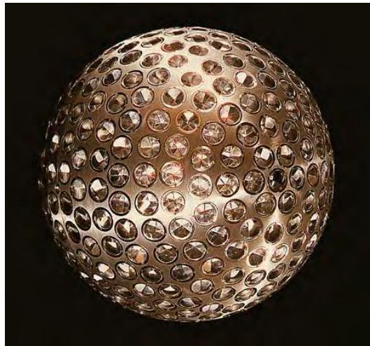
FIGURE 2.1 – Un satellite géodésique passif LAGEOS, source NASA
