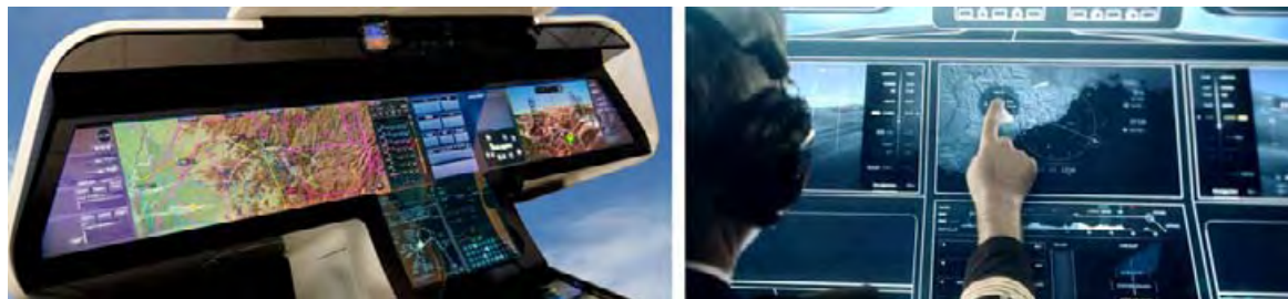
Figure 149 : Nouveaux concepts de cockpit étudiés par Thales, démonstrateur ODICIS de surface continue (à gauche), Cockpit avionics 2020 (à droite)
