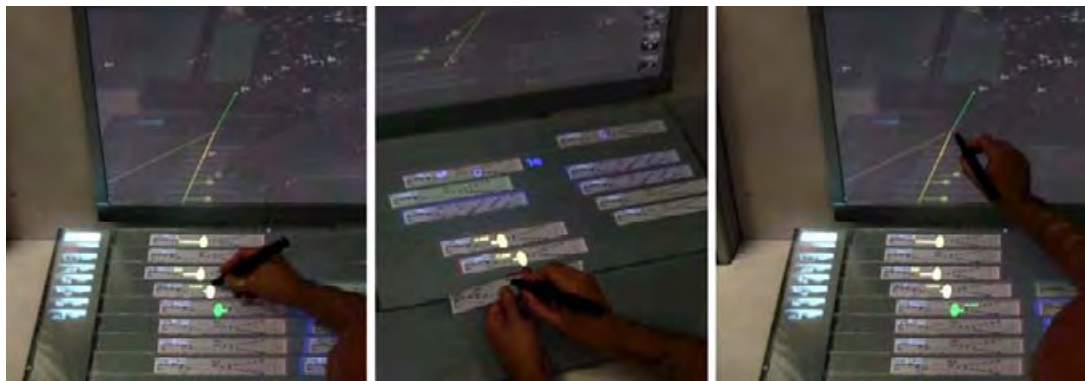
Figure 106 : Interaction de filtrage réalisé avec le stylo Anoto : à partir d'un strip positionné sur le tableau (à gauche), avec un strip hors tableau (au centre), à partir de l'image radar (à droite).
