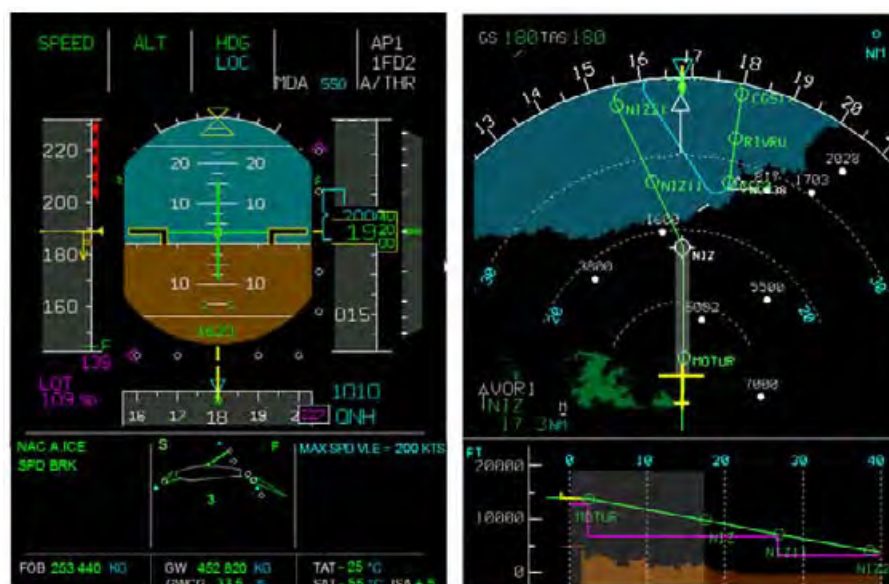
Figure 22 : Les écrans EFIS du cockpit intègrent (à gauche) le Primary Flight Display (PFD), et (à droite) le Navigation Display (ND).
