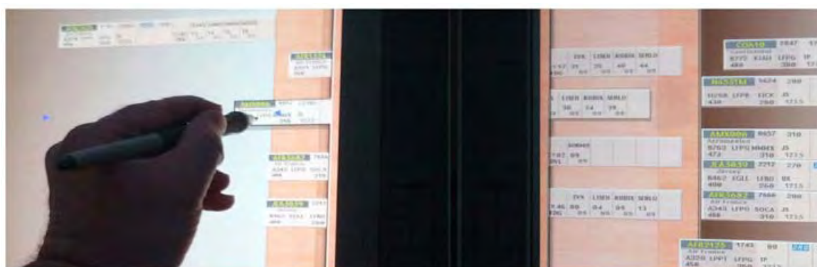
Figure 11 : Animations graphiques dans DigiStrips : animation synchrone d'un même objet entre deux écrans (à gauche), feedback animé d'une sélection de clearance avec un nouveau niveau de vol (à droite).
