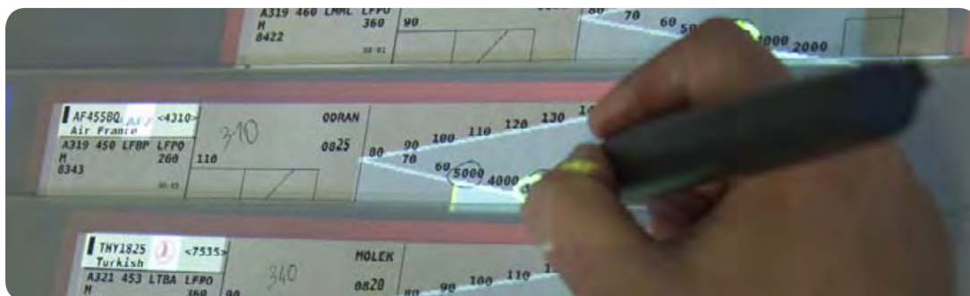
Figure 114 : Un strip tangible « AF455BQ » associant strip papier, impression carbone des informations plan de vol, saisies manuscrites à l'encre du contrôleur, projection inférieure du porte-strip et informations augmentées projetées sur le strip
