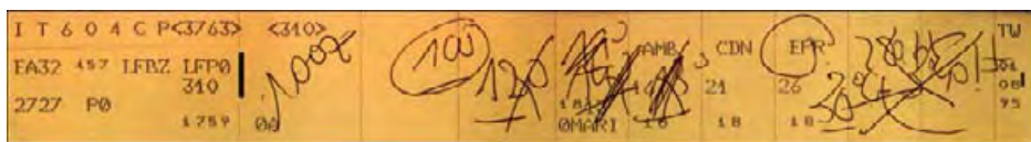
Figure 84 : Un strip papier de contrôle en-route avec les informations imprimées de plan de vol et les annotations et instructions manuscrites du contrôleur
