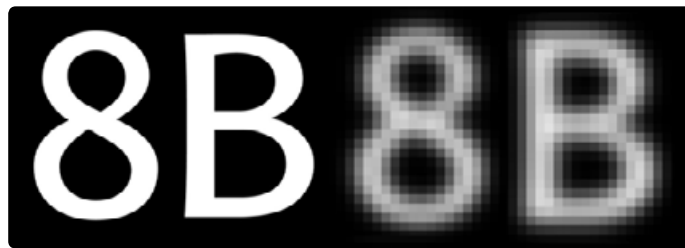
Figure 51 : Modification des formes du « B » et du « 8 » pour améliorer la discrimination visuelle des caractères.
