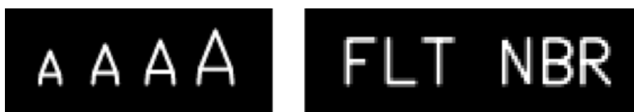
Figure 29 : Rendu du caractère « A » dans les 4 tailles de fonte avec une épaisseur de tracé constante (à gauche), espacements visuels hétérogènes entre différents caractères affichés par une fonte CDS (à droite).
