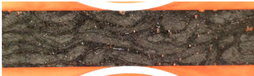
FIGURE 4.7 – Section du renfort UD fabriqué par enroulement filamentaire
