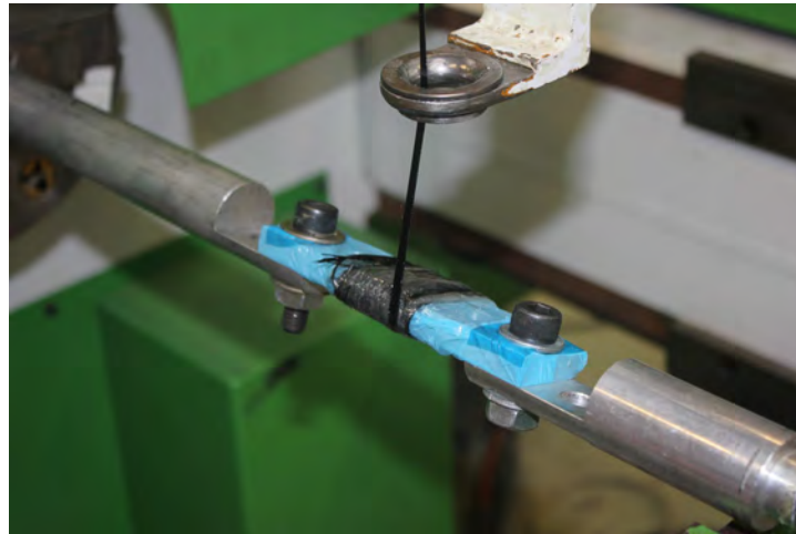
FIGURE 4.6 – Enroulement filamentaire de la fibre XN-90-60S
