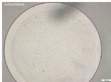
Figure 111. Après développement de la résine SU8 non réticulée ayant subi une métallisation Ti/Cu et deux attaques chimiques, une du cuivre, l'autre du titane.
