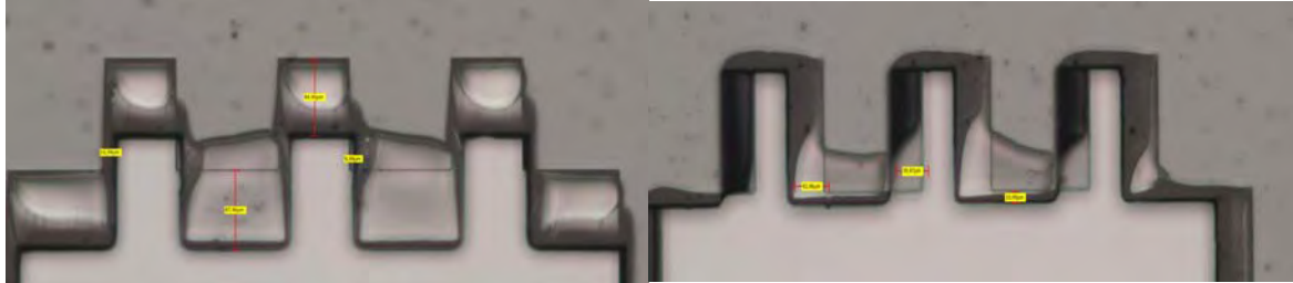
Figure 65: Exemple de désalignements dus à la déformation du PET lors du PEB
