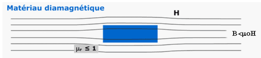
Figure 26. Visualisation des modifications des lignes du champ magnétique par l'introduction d'un élément diamagnétique
