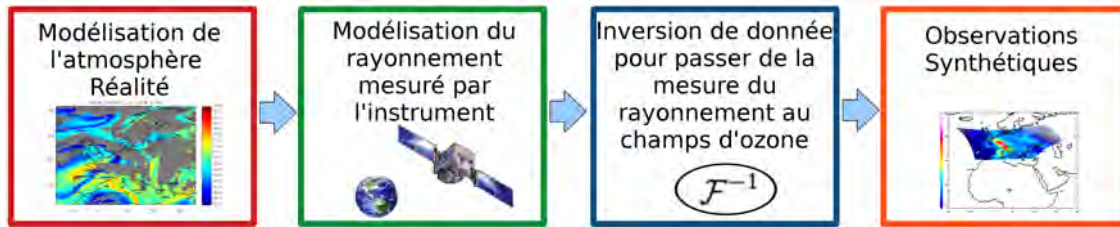
FIGURE 2.1 – Illustration de la chaîne de modélisation utilisée permettant de simuler les observations synthétiques d'un instrument à bord d'un satellite géostationnaire.
