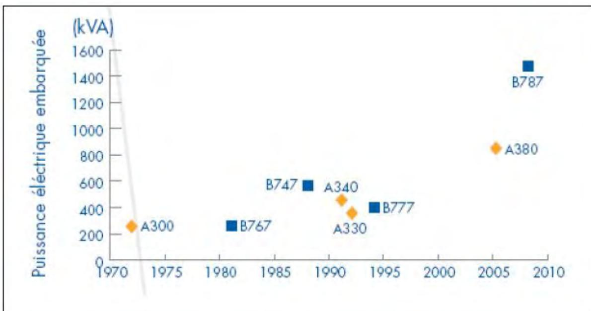
Figure I-19 : Evolution de la puissance embarquée [17].
