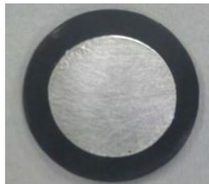
*Figure F-3 : Composant avec électrode obtenue par sérigraphie directe*
