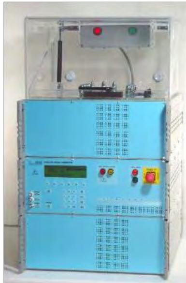
*Figure III-17 : Générateur d'ondes de chocs normalisées MIG0624TK-12*
