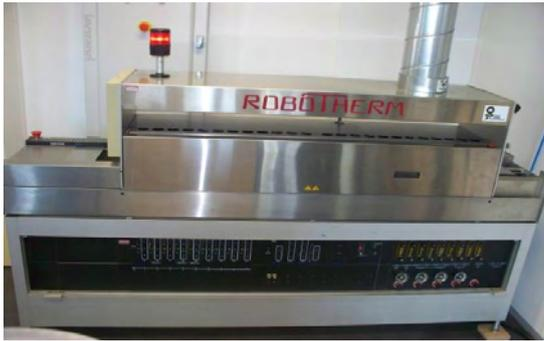
Figure F-4 : Four à passage Robotherm utilisé pour le brasage des connectiques.
