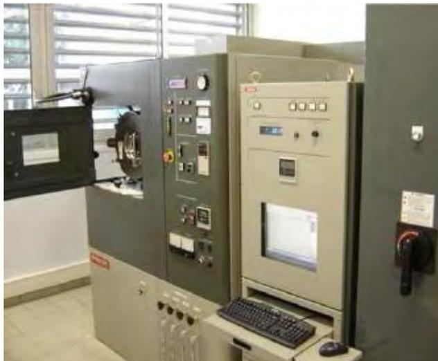
*Figure II-12 : Vue d'ensemble de la machine SPS Dr Sinter 2080*
