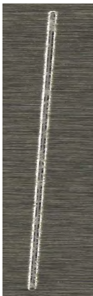
Figure II. 11 - Blessure de 100 \mu\text{m} sur 15 mm avec force constante (25 N) à l'aide du microscratch test
