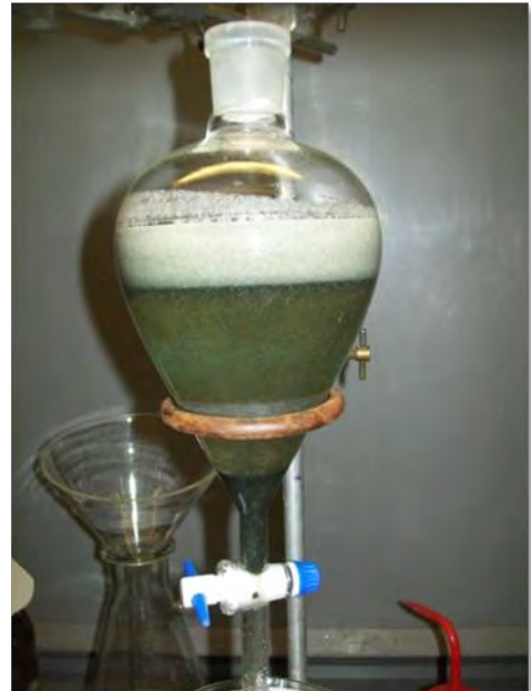
Figure 3 Ampoule à décanter remplie de bromoforme : fraction légère flottante et lourde proche du robinet.
