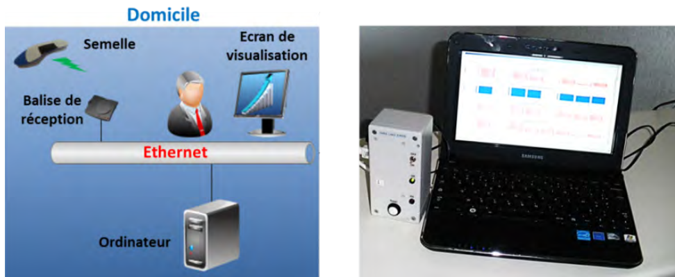
Figure 82. Architecture système installée à domicile
