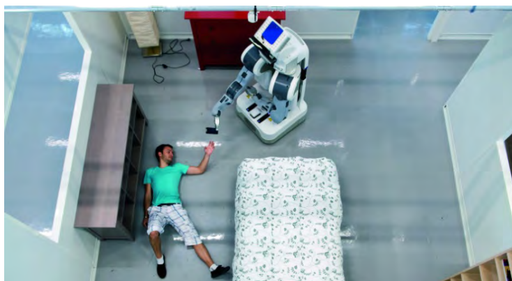
Figure 5. Expérimentation LAAS-CNRS : suite à une chute détectée, le robot vérifie la situation
