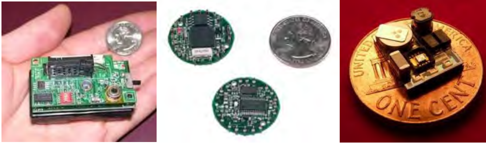
Figure 10. Exemples de nœuds capteurs miniatures et évolution dans la miniaturisation
