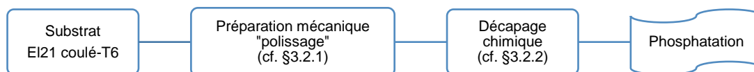
Figure 45. Protocole de préparation des couches de conversion phosphatées, à partir d'une solution de \text{H}_3\text{PO}_4 .
