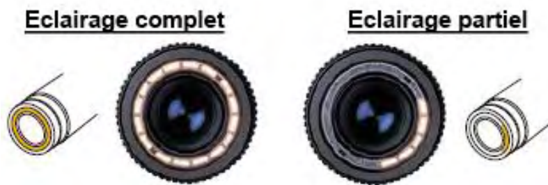
Figure 20. Fonction de décalage de la lumière de l'anneau d'éclairage : éclairage complet (à gauche) et éclairage partiel (à droite) [216].
