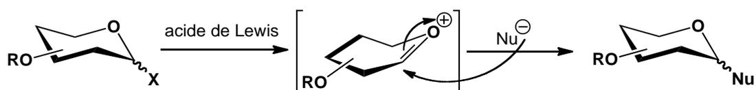
**Schéma 26.** Principe de l'activation anomérique, en vue de son utilisation pour Nu = N<sub>3</sub>.
