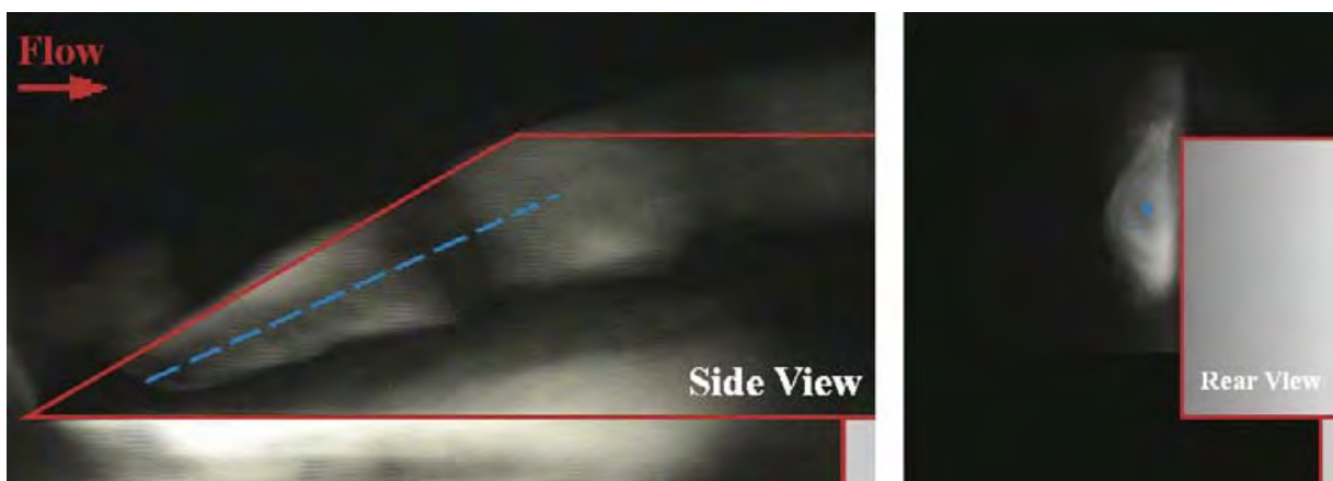
FIGURE 2.3 – Visualisation par fumigène de l'écoulement de contournement de montant de baie. Les contours de la maquette sont représentés en rouge et l'axe approximatif du phénomène en bleu [Levy et al. (2008b)].
