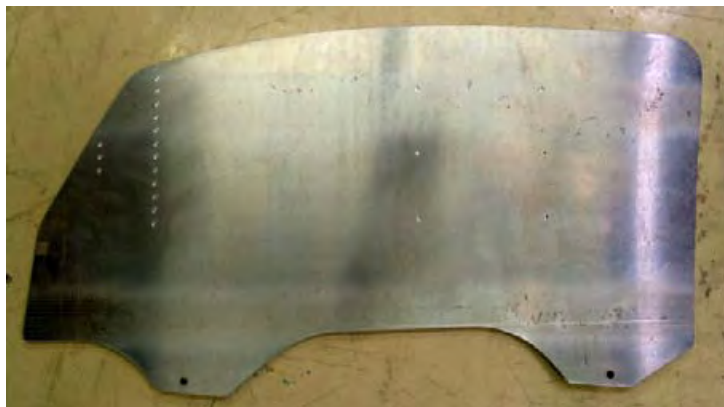
FIGURE 6.1 – Vitre en aluminium permettant de faire des mesures de pression pariétale non intrusives lors d'essais sur Peugeot 1007.
