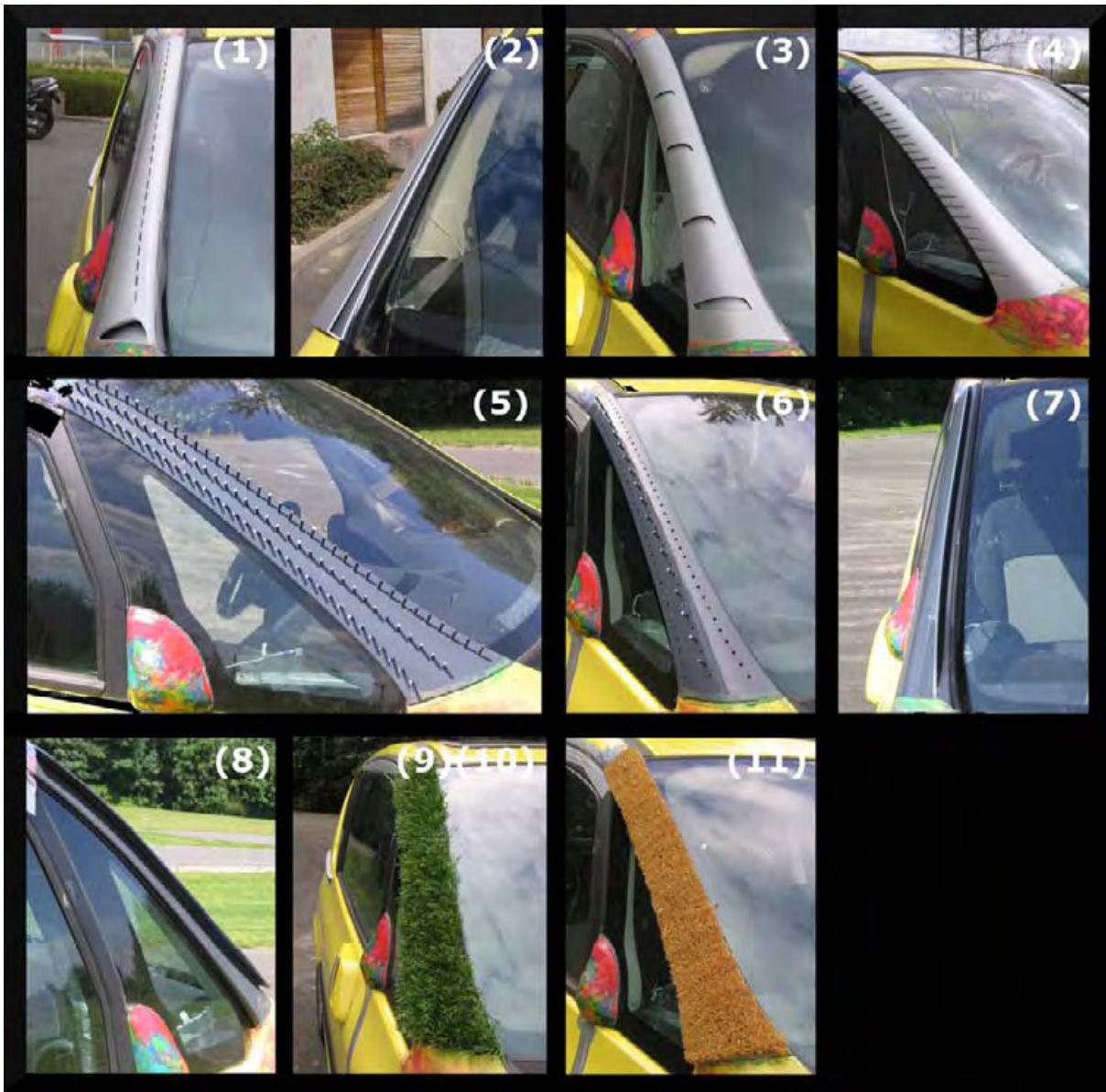
FIGURE 5.3 – Prototypes usinés et testés pour Peugeot 1007 : (1) soufflage dessus ; (2) soufflage côté ; (3) ouïes ; (4) dents de scie ; (5) VG108 ; (6) VG18 ; (7) lamelle rigide ; (8) lamelle souple ; (9) gazon ; (10) gazon gel ; (11) paillason.
