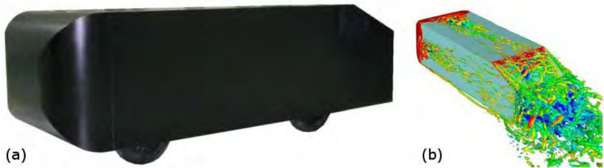
FIGURE 1.2 – (a) Corps de Ahmed à l’échelle 1 dans la soufflerie S2A. L’avant, à gauche, est profilé pour minimiser les perturbations sur l’écoulement de culot à l’arrière (photo de l’auteur) ; (b) Simulation numérique de l’écoulement autour du corps de Ahmed [TUBerlin (NC)].
