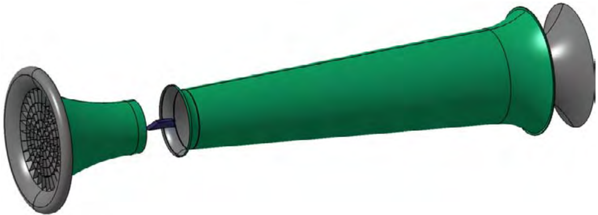
FIGURE 2.2 – Schéma de la soufflerie, la maquette est posée sur un mât à mi-hauteur de la section.
