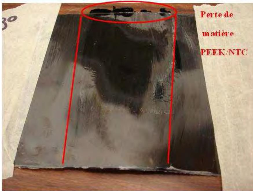
Figure 5-23 : pli de prepreg et film PEEK/NTC 40x40 mm<sup>2</sup> après mise en œuvre sous 6 bars
