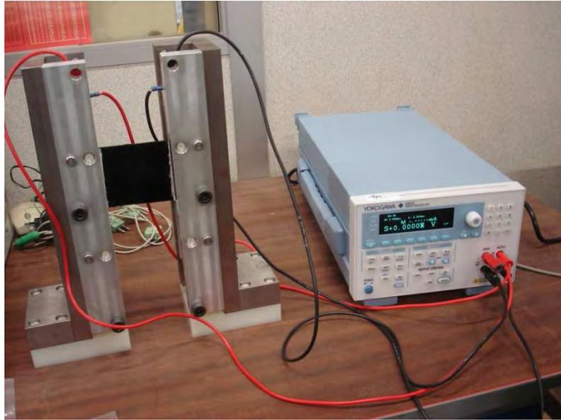
Figure 2-18 : Photo du montage expérimental pour les mesures de conductivité à l'ambiante
