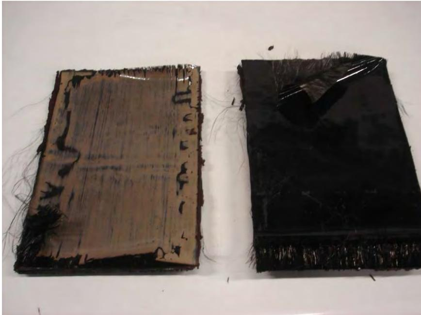
*Figure 5-27 : Photo échec de la conception des plaques réalisées par film stacking à l'autoclave*
