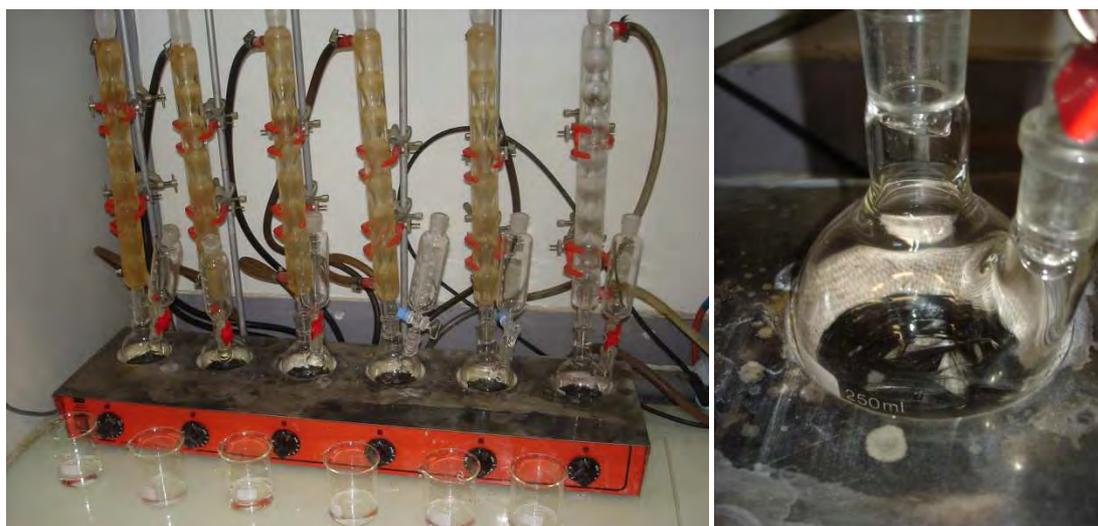
*Figure 2-23 : Montage expérimental du poste de dissolution chimique et ballon avec polymère dissout et fibres de carbone- ICA Toulouse*
