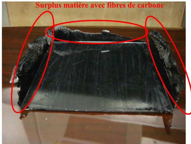
Figure 5-20 : Composite sandwich PEEK/fibres de carbone/NTC 3%wt avec surplus de résine
