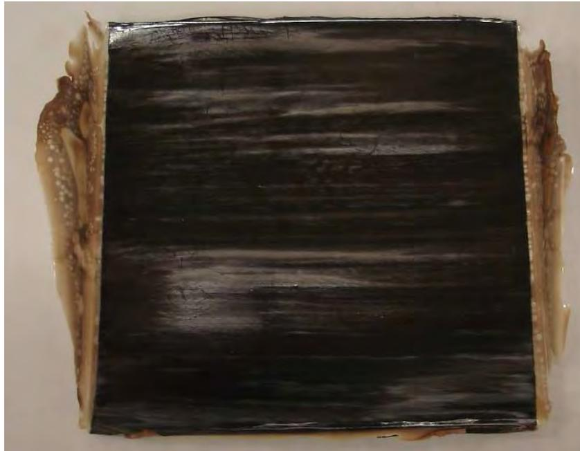
Figure 5-28 : Photo d'un pli de fibres sèches imprégné avec un film de PEEK pur
