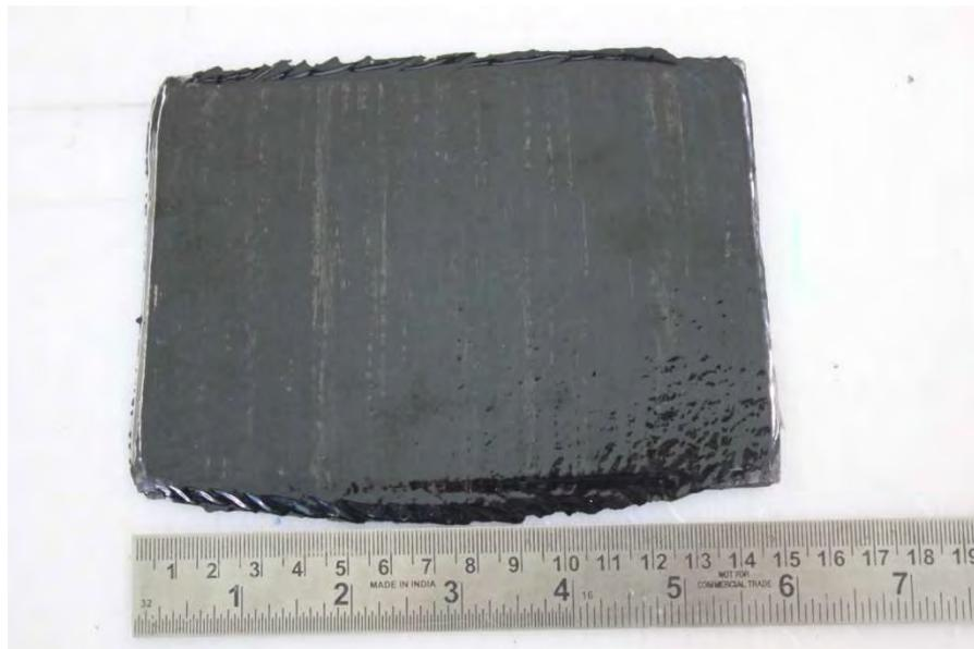
Figure 5-26 : Photo de la plaque obtenue par « film stacking »
