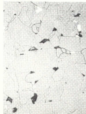
AVCO, 14 μm x 40 μm TABULAR GRAINS
