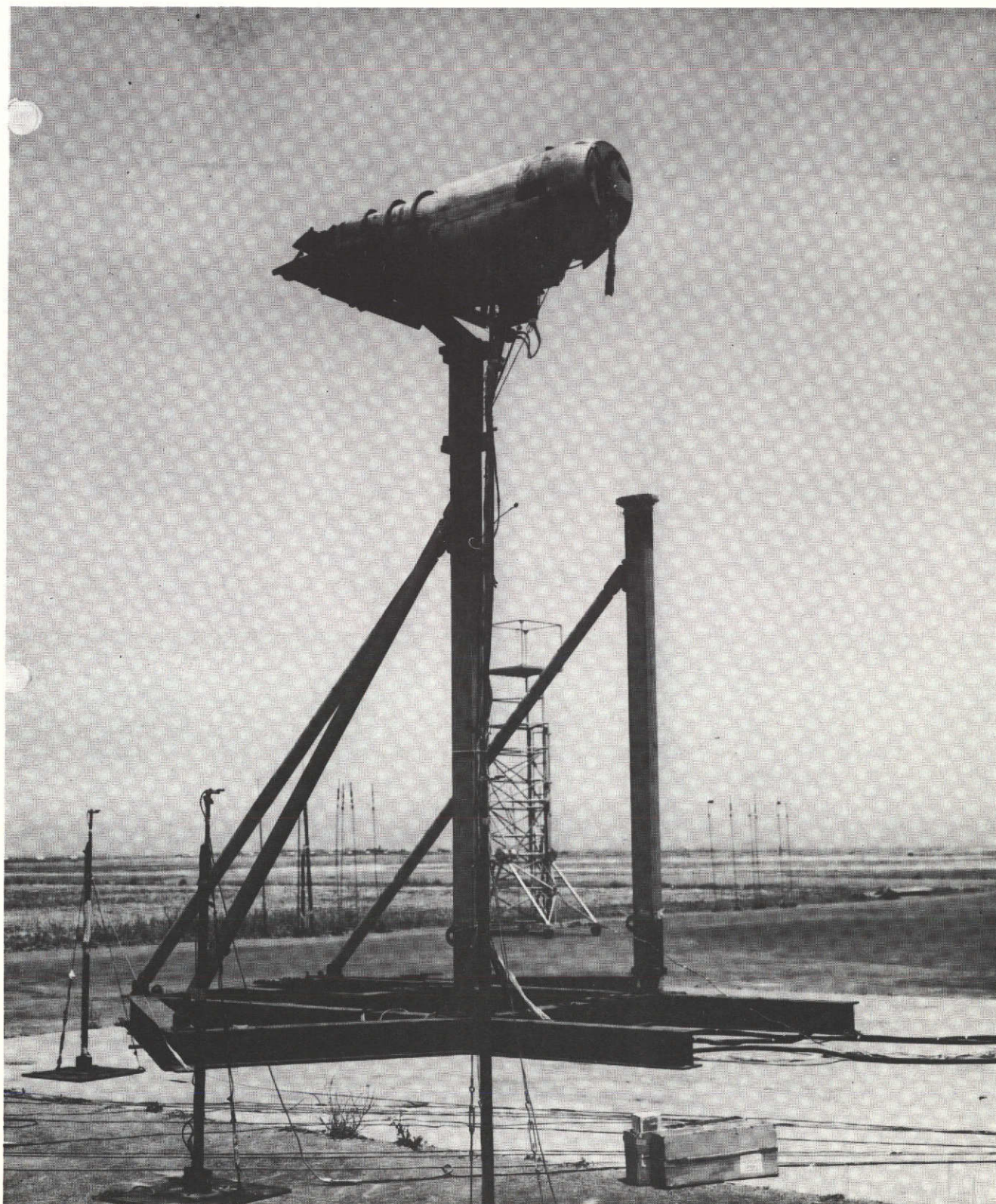
(d) Nacelle installed in static test facility
