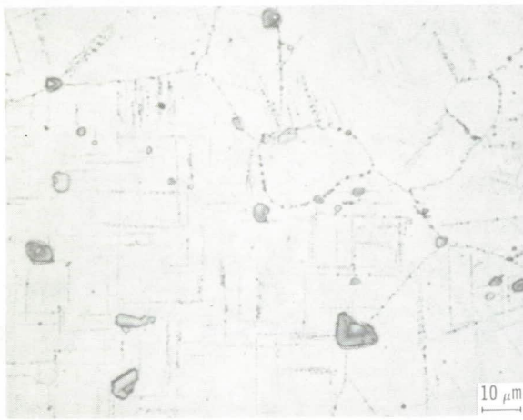
(c) High Al + Ti content (very sigma prone); etch, KOH.
