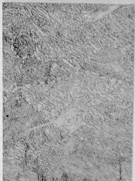
(d) Tempered & quenched at 650°C
