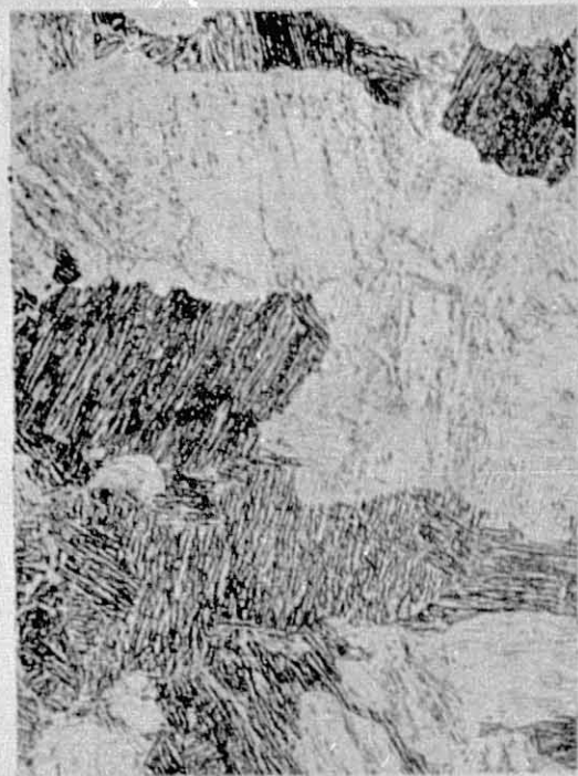
(d) Tempered & quenched at 650°C
