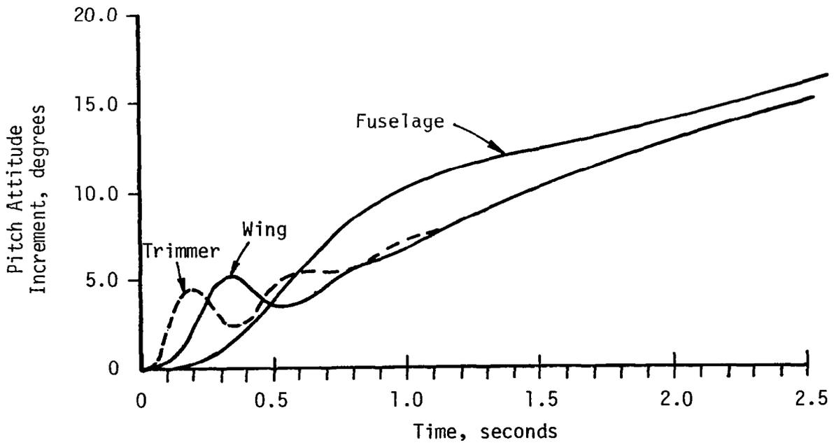
FIGURE 8. RESPONSE TO STEP LONGITUDINAL CONTROL INPUT, FORWARD TRIMMER/STRAIGHT WING, CRUISE
