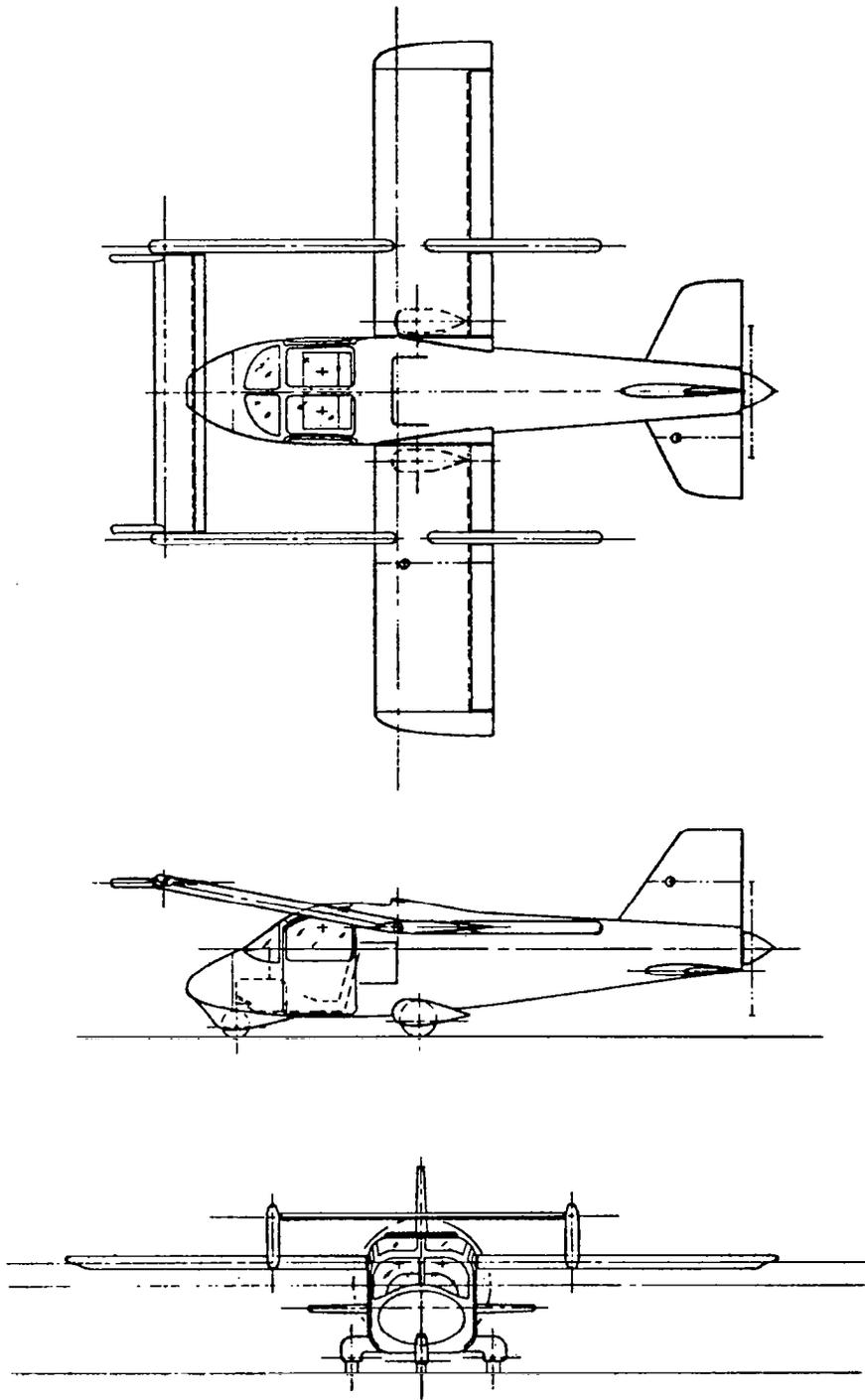
FIGURE 3. FORWARD TRIMMER CONFIGURATION FROM REFERENCE 8
