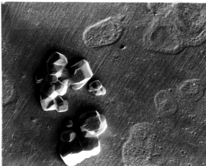
Bild 17: Oberfläche von Stahl 13CrMo44 nach 500 h in  $MgCl_2$ -NaCl bei 485°C, flache Mulden,  $MgCl_2$ -NaCl-Kristalle, REM, 60 x
