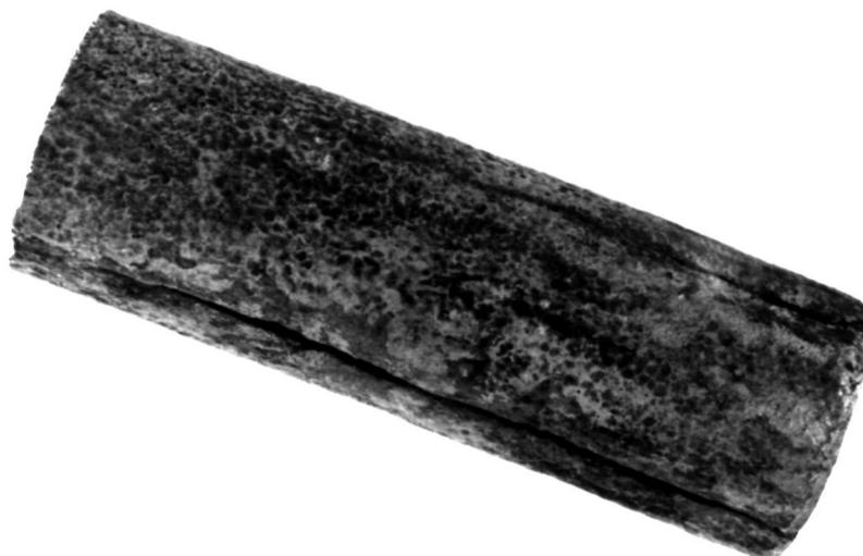
Bild 18: Behälter aus CuNi10Fe nach 200 h bei 485°C gefüllt mit  $MgCl_2$ -NaCl, Längsrisse in Behälterwand, 1,5 x
