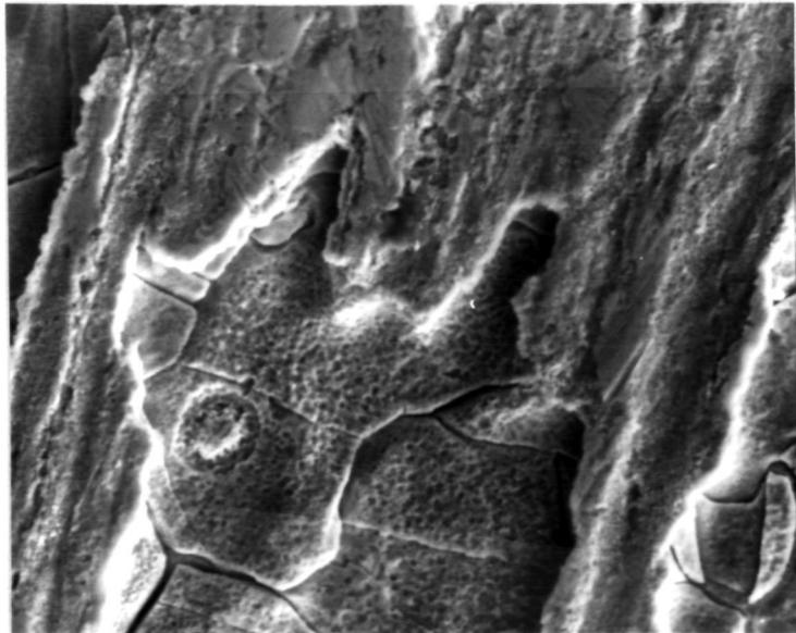
Bild 14: Ausschnitt aus Bild 13, CuNi10Fe nach 500 h in  $\text{NaNO}_3$  bei  $355^\circ\text{C}$ , REM, 900 x
