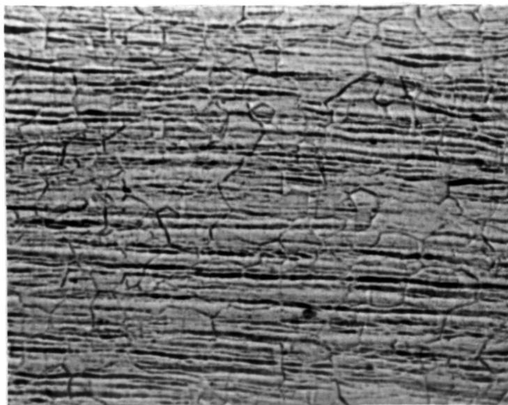
Bild 19: Gefüge eines Rohrabschnittes aus CuNi10Fe, nicht korrodiert, 350 x
