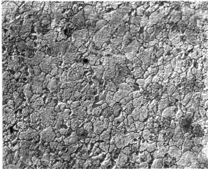
Bild 8: Korngrenzenangriff und muldenförmige Abtragungen an St35 nach 500 h in KCl-ZnCl<sub>2</sub> bei 280°C, REM, 135 x
