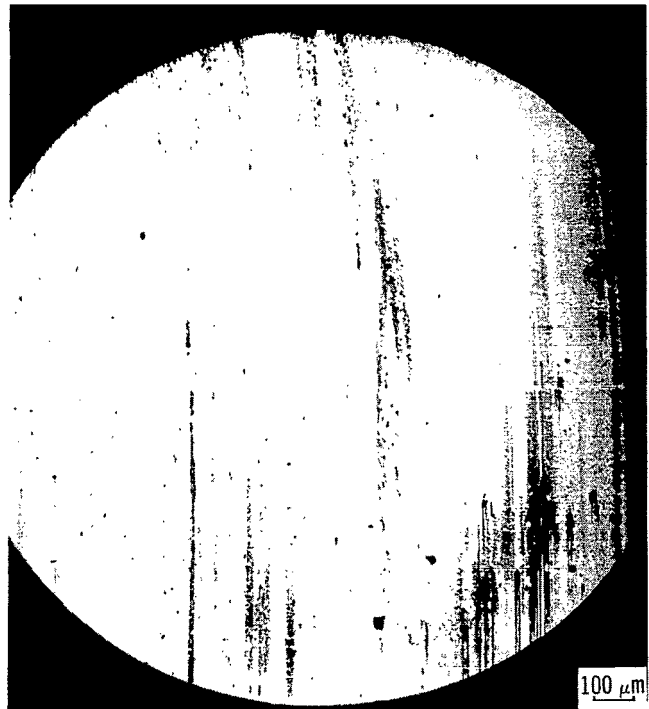
(d) After 1800 kilocycles of sliding.
