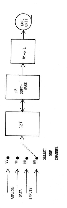
FIGURE 8.9. SINGLE CHANNEL CZT SYSTEM
