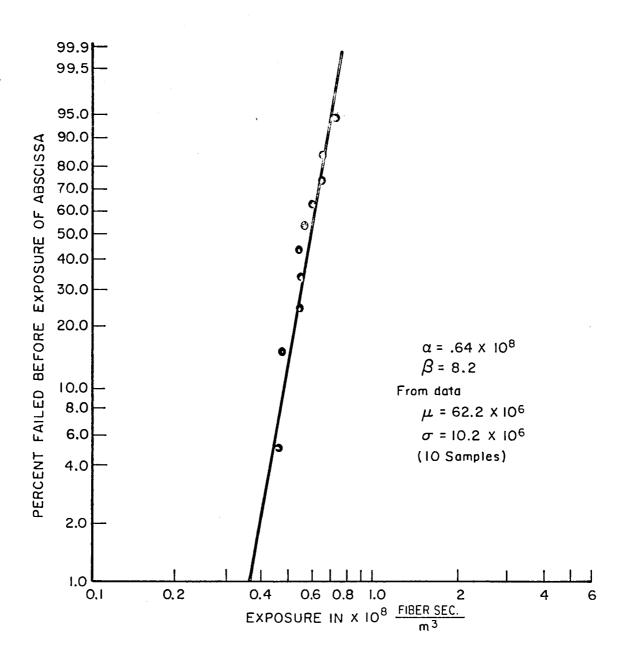
FIGURE 3.2 EXPOSURE TO FLASHOVER FOR WET 15kV DISTRIBUTION POST, 2mm FILTERS.
