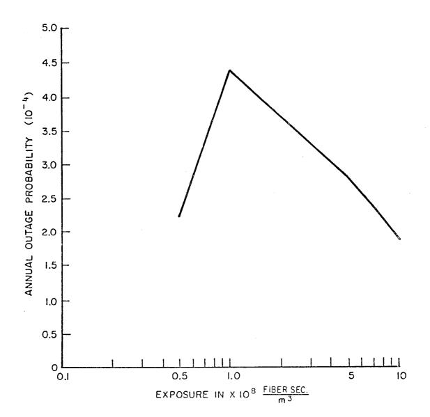
FIGURE 3.6 - ANNUAL OUTAGE PROBABILITY VERSES EXPOSURE LEVEL FOR 7.5kV POWER SYSTEM
