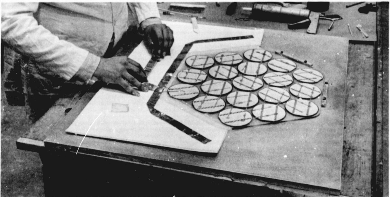
(d) Positioning Positive Termination Strip
