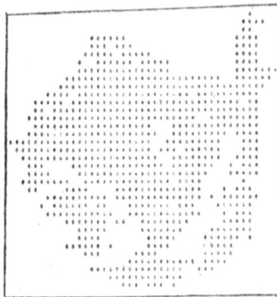
Fig. 3.12 - Saída de classificação automática de cana através do subsistema IMPRESSORA.
