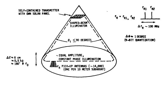
HOTE: PICK-UP ANTENNA ORTHOGONALLY POLARIZED WITH RESPECT TO POWER BEAM TOTAL ISOLATION  $I_T \ge 40 + 60 \text{ dB} \ge 100 \text{ dB}$ CROSS POL FRONT-TO-BACK RATIO (CAN BE MADE >100 dB)
