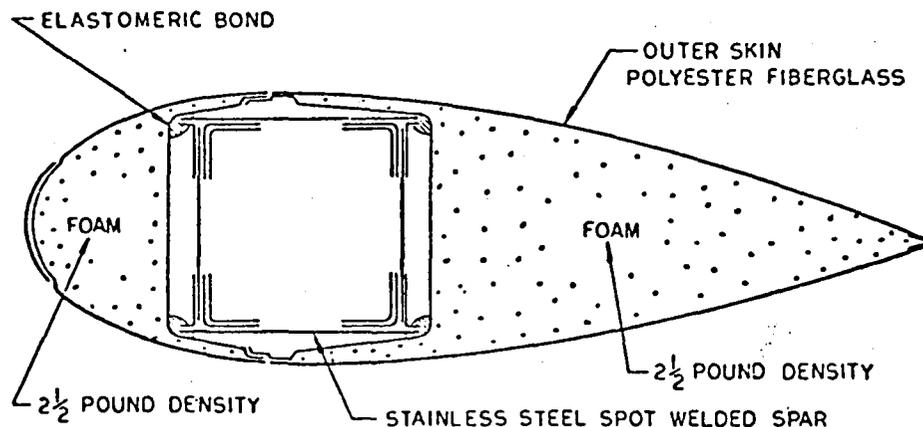
FIGURE 7 - TYPICAL SECTION WIND TURBINE BLADE
