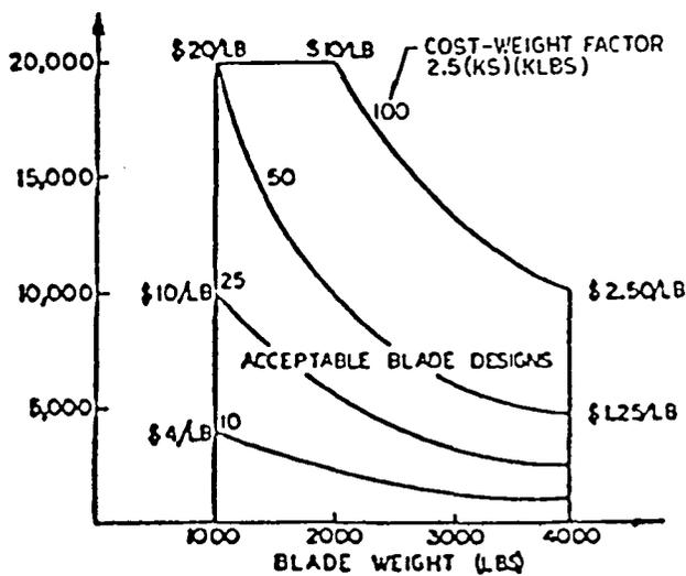
FIGURE 6 - BLADE WEIGHT VERSUS BLADE COST
