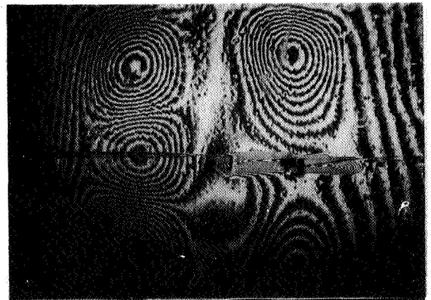
(d) Moire-fringe photo after damage propagation.
