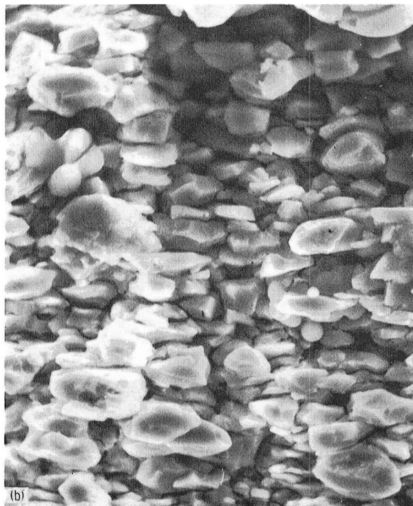
(a) 30 vol % SiC p . (b) 40 vol % SiC p .
