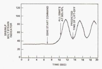
FIGURE 6.- FLIGHT READINESS FIRING TIEDOWN BOLT STRAIN.
