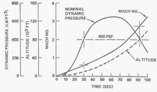
FIGURE 7.- TYPICAL HIGH-q BOOST TRAJECTORY DATA.
