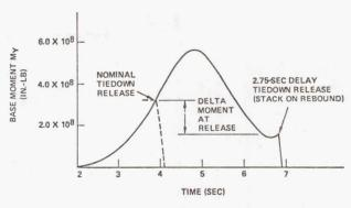
FIGURE 5.- DELAYED SRB IGNITION BASE M $_{\gamma}$  VERSUS TIME.
