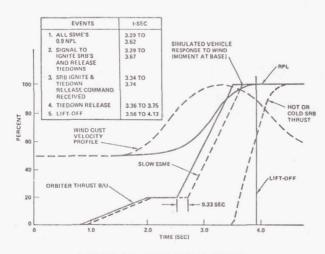
FIGURE 2.- LIFT-OFF SEQUENCE.
