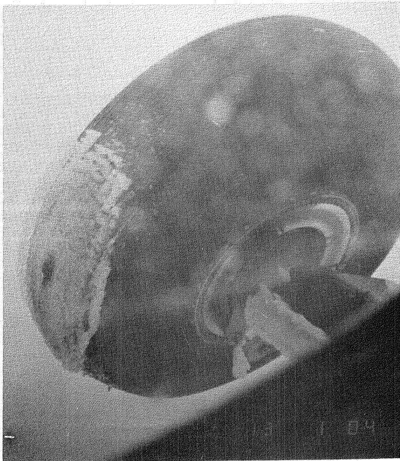
(d) Ice formation on wheel and landing gear strut.
