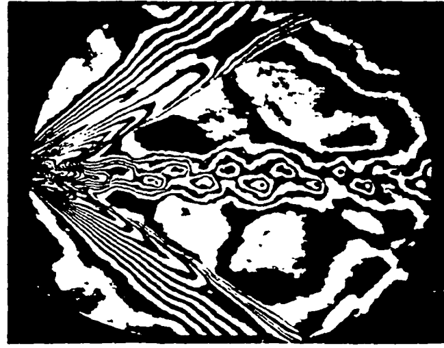
Bild 5. Wirbelstraße im Überschall, Ma = 1,5 (Mach-Zehnder-Interferogramm mit Linien konstanter Dichte).
