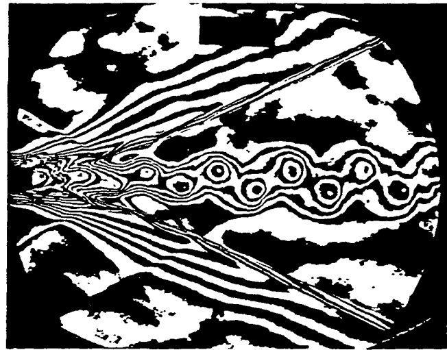
Bild 7. Wirbelstraße im Überschall, Ma = 2,2 (Mach-Zehnder-Interferogramm mit Linien konstanter Dichte).
