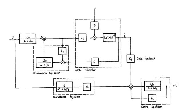
Figure 9 : 2<sup>nd</sup> CONTROL CONCEPT : STATE ESTIMATION AND FEEDBACK USING FREQUENCY-SHAPED TECHNIQUES
