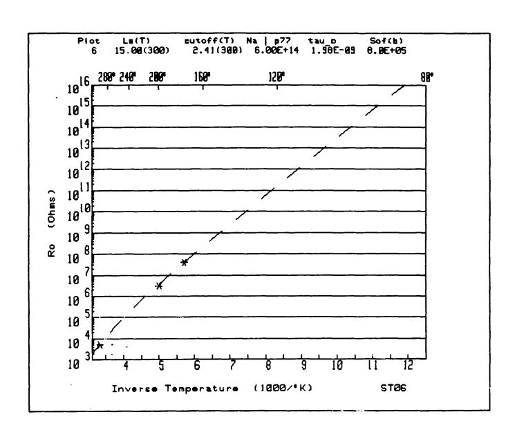
FIGURE 4. ANALYSIS OF THE Ro TEMPERATURE DEPENDANCE SHOWS HIGH GR CURRENTS DOMINATE MODERATE TEMPERATURE PERFORMANCE.
