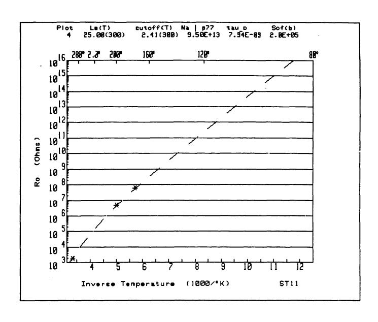
FIGURE 3. ANALYSIS OF THE Ro TEMPERATURE DEPENDANCE SHOWS HIGH GR CURRENTS DOMINATE MODERATE TEMPERATURE PERFORMANCE.
