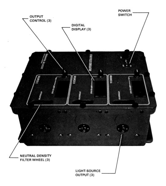
FIGURE 1. STAR FIELD SIMULATOR CONTROL UNIT
