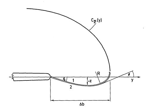
Fig. 4 Tip jet parameters.
