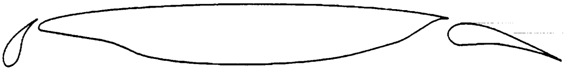
(d) 12-percent leading-edge flap configuration.
