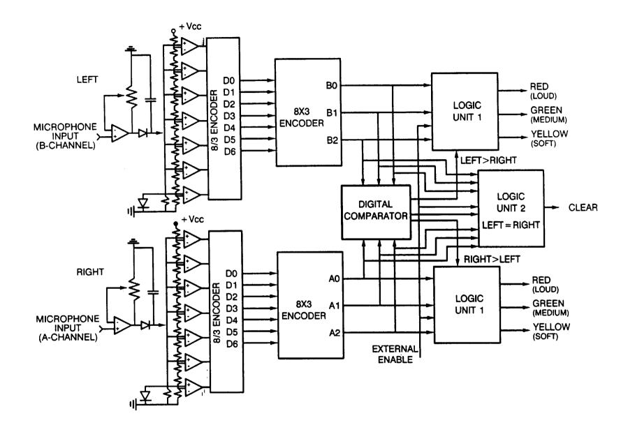
FIGURE 1 BLOCK DIAGRAM OF THE SYSTEM ELECTRONICS FOR THE EYEGLASS ASSEMBLY
