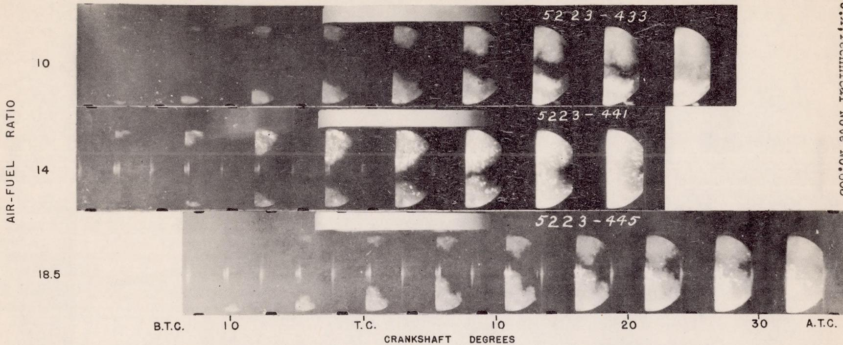
FIGURE 7.- ENLARGEMENTS OF PHOTOGRAPHS OF FLAME FORMATION AT
